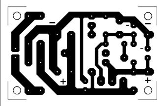
Der ideale Transformator für diese Netzteil sollte eine Sekundärspannung von 15 Volt haben und dabei einen Strom von 2,2 Ampere liefern. Der **Ladekondensator C2** ist so zu dimensionieren, daß auf einen Strom von 1 mA etwa 1 - 2  $\mu$ F Kondensatorkapazität entfallen. Bei 1000 mA genügen also 1000 - 1500  $\mu$ F. Die Platine ist so ausgelegt, daß für C2 auch zwei Kondensatoren parallel geschaltet werden können.
