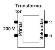
Primär- und Sekundärseite eines Trafos dürfen nicht verwechselt werden. Daher müssen die Spulenwiderstände mit dem Multimeter gemessen werden. Die **Primärseite** (230 Volt) hat einen **höheren Spulenwiderstand** als die Sekundärseite.
