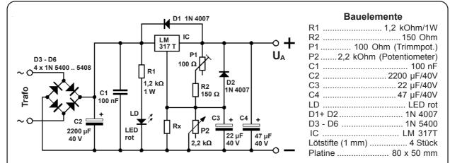
Mit dem Spannungsregler-IC LM 317T läßt sich ein vielseitig verwendbares Netzgerät aufbauen. Die Ausgangsspannung kann je nach verwendetem Transformator zwischen 1,25 Volt und maximal 37 Volt bei einem Strom von 1,5 Ampere eingestellt werden. Dazu werden im Prinzip nur die Widerstände R2 und eventuell Rx, das Trimmpotentiometer P1 und das Potentiometer P2 benötigt. Der LM 317 T verfügt über ein besseres Regelverhalten als die Festspannungsregler und ist intern gegen Überlastung geschützt.
