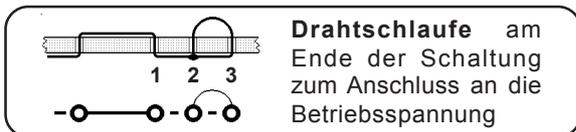
Herstellung der **Drahtschleife zum Anschluss an die Betriebsspannung**: Der Draht wird von **Loch 1** ausgehend von unten durch **Loch 3** gezogen, dann wird die Schleife gebildet (ca. 5 mm hoch), indem der Draht von oben durch **Loch 2** gezogen wird. An der Rückseite etwa 3 mm überstehen lassen, jetzt den Draht umbiegen und verlöten!
